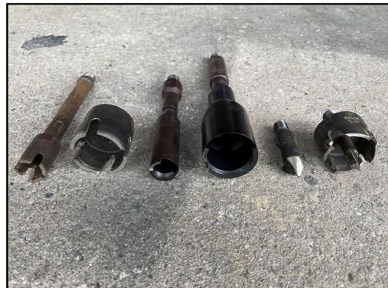
【向かって左から、VP 用、HPP 用、DIP 用それぞれ  $\phi 25\text{mm}$ 、 $\phi 50\text{mm}$ 】
