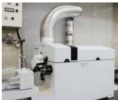
▲金属類の測定に使用する誘導結合プラズマ質量分析装置
